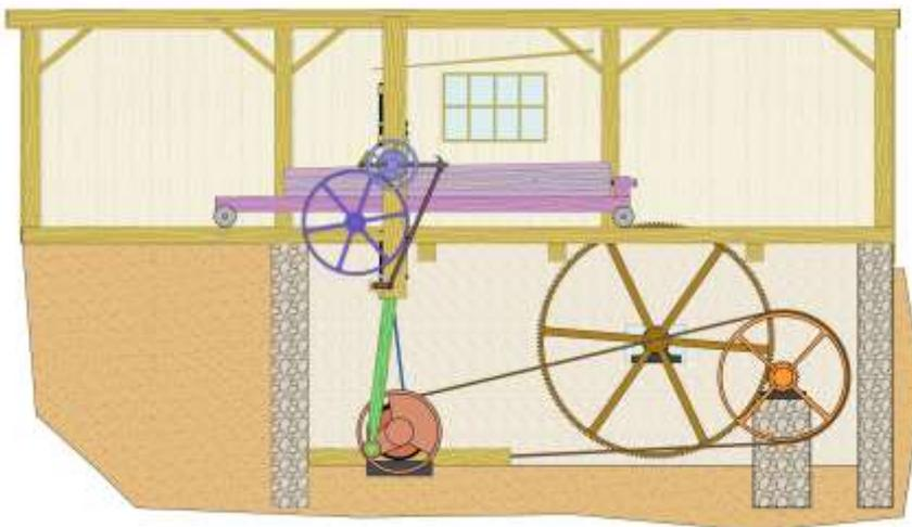
La grosse roue en fonte, aux dents de bois, est solidaire de la roue à augets et a un diamètre identique. L'ensemble des poulies, courroies et engrenages permettent de multiplier la vitesse de rotation par 10. Lorsque le *sagard* tire la deuxième corde, il déplace la courroie provoquant la mise en mouvement du cadre de la scie.
