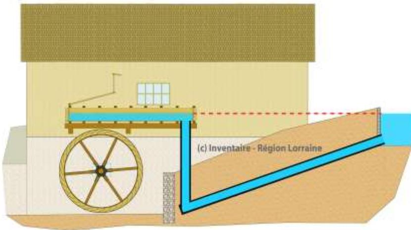
L'étang-réservoir situé à l'arrière du bâtiment est alimenté par un canal qui dérive une partie des eaux du ruisseau tout proche. Une conduite souterraine formant un siphon relie l'étang à l'auge de bois située au-dessus de la roue. Le niveau de la surface de l'étang correspond horizontalement à 50 centimètres d'eau dans l'auge.
